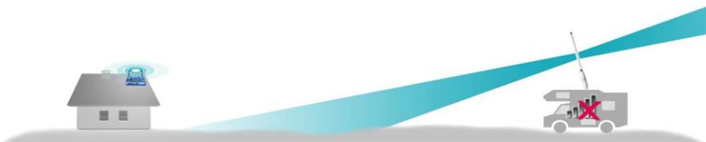
Beachten Sie, dass bei großem Höhenunterschied zum WLAN-Hotspot durch die Abstrahleigenschaften der Antenne nur schlechte bis keine Verbindung hergestellt werden kann.
