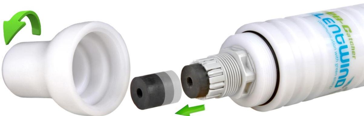
Schrauben Sie die Verschlusskappe vom Antennengehäuse ab und ziehen Sie den Kabel-Dichteinsatz aus der Fassung heraus.
