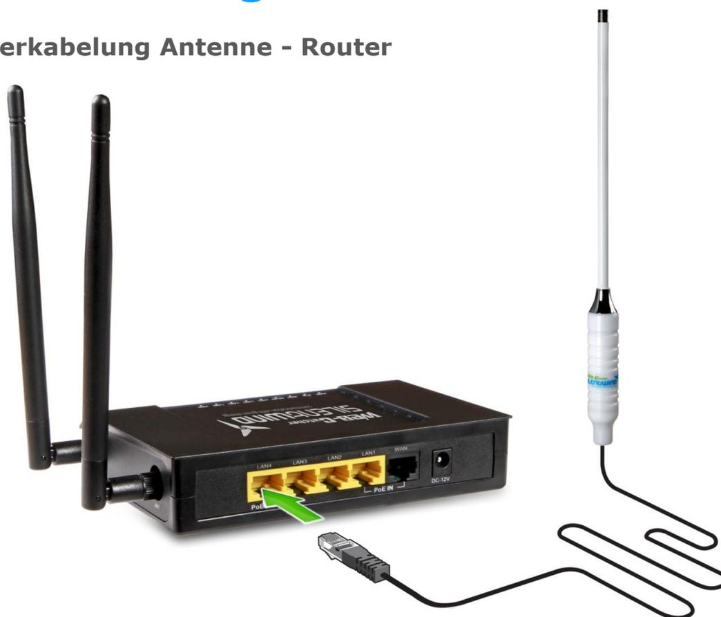
Verbinden Sie das Anschlusskabel der Antenne mit dem linken Port **LAN4** am WLAN-Router (von hinten betrachtet).
