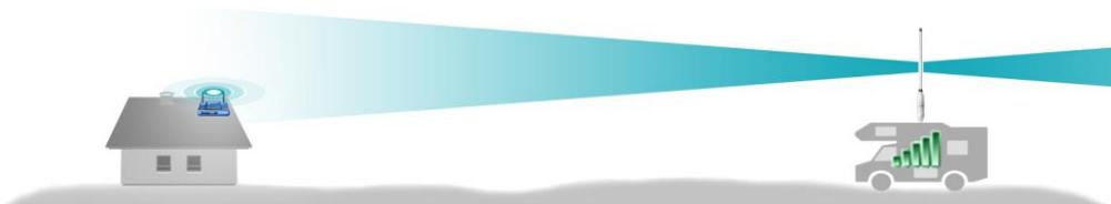
Bei falscher Antennen-Positionierung oder Neigung, ist die maximale Reichweite stark eingeschränkt.
