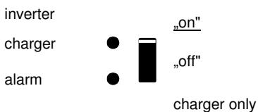
Die Netzspannung ist durchgeschaltet und das Ladeteil ist ausgeschaltet.
