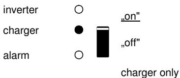
Die Netzspannung ist durchgeschaltet und das Ladeteil liefert Konstantstrom (bulk phase) oder Konstantspannung (absorption phase).
