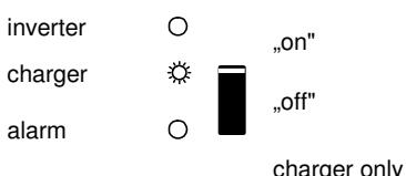
Die Netzspannung ist durchgeschaltet und das Ladeteil lädt mit Ladeerhaltungsspannung (float-Modus).
