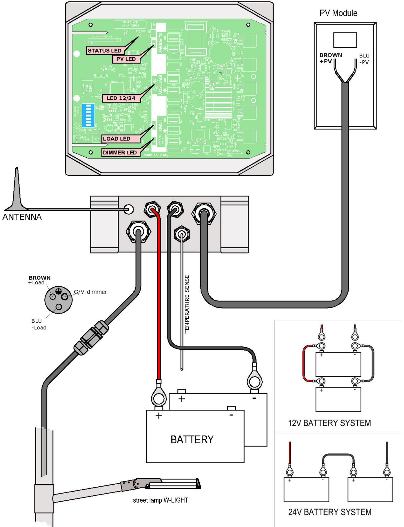
Fig. 2 Wiring scheme
