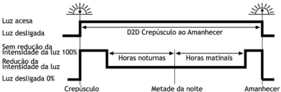
2. Carga modo D2D, redução da intensidade da luz do modo D2D
