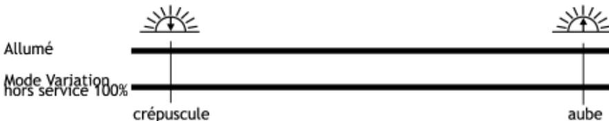
Remarque : Il est possible d'activer le mode de variation depuis l'état de charge (SOC) de la batterie. Définir une valeur à l'aide du commutateur rotatif 10 ; si la tension de la batterie chute en dessous de cette valeur, la fonction de variation s'active.
