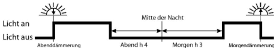
Stunden basierend auf Abend- und Morgendämmerung (Schiebeschalter nach unten).
