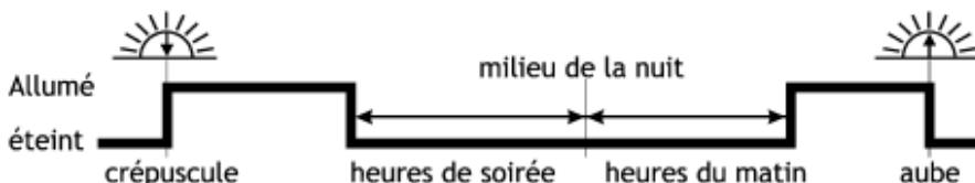
Heures calculées en fonction du crépuscule et de l'aube (interrupteur vers le bas).
