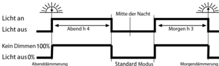
Nacht- und Tagerkennungsspannung (Leerlaufspannung):
