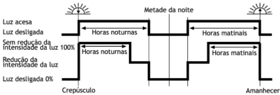
3. Carga noturna/matinal, redução da intensidade da luz D2D (Crepúsculo ao Amanhecer) (comutador rotativo 9).
