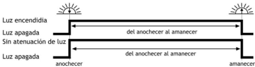
3. Modo de carga D2D del anochecer al amanecer, modo de apagado de atenuación de luz
