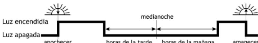
Horas basadas en anochecer y amanecer (interruptor deslizante hacia abajo).
