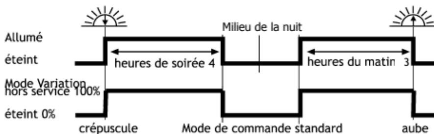
1) Désactiver les heures du matin et de soirée pour mettre le mode Variation hors service. Les charges restent toujours sous tension si aucun incident ne survient (LVD/SOC, surintensité).
