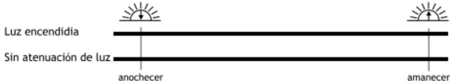
NOTA: La atenuación de luz puede ser activada también mediante el SOC (estado de la carga) de las pilas. Determine un valor usando el interruptor giratorio 10; y si la tensión de las pilas cae por debajo de dicho valor, se activará la función de atenuación de luz.
