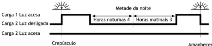
Tensão de Detecção Noite e Dia (tensão solar de circuito aberto):
