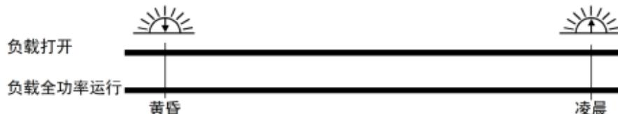
**注释:** 功率调节功能也有低压保护功能 (SOC/LVD)，旋转开关 10 用于设置其数值。如果蓄电池电压低于设定值，负载调节功能开。
