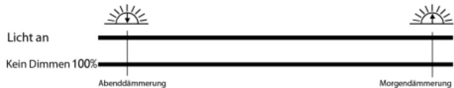
**Anmerkung:** Dimmen kann abhängig vom Batterie SOC sein. Setzen Sie einen Wert durch Drehung des Schalters 10; falls die Batteriespannung unter diesen Wert fällt, wird die Dimm-Funktion aktiviert.
