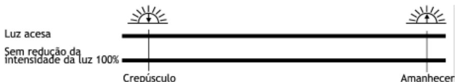
Observação: A redução da intensidade da luz pode ser ativada com base no estado da carga da bateria. Ajuste um valor através do comutador rotativo 10; se a tensão da bateria cair abaixo do valor, a função de redução da intensidade da luz será ativada.
