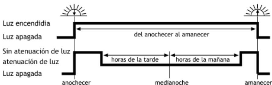
2. Modo de carga D2D del anochecer al amanecer, modo de atenuación de luz D2D del anochecer al amanecer
