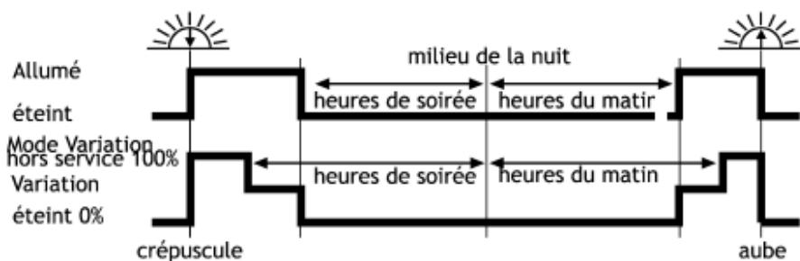
2. Heures calculées en fonction du crépuscule et de l'aube (interrupteur à bascule vers le bas).
