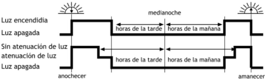
2. Horas basadas en anochecer y amanecer (interruptor deslizante hacia abajo).
