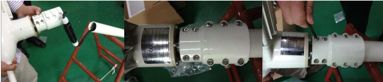
Schiebe das Kabel durch den Mast
