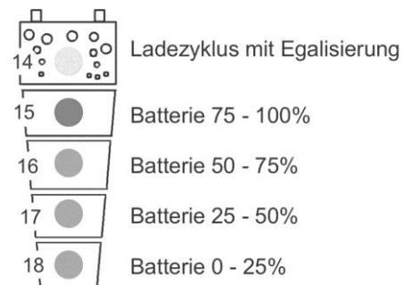
Das im COMPACT eingebaute Messsystem berücksichtigt die Batteriespannung, den Entlade- respektive den Ladestrom sowie die Welligkeit der Spannung. Werden die Batterien und der COMPACT entsprechend deren technischen Daten betrieben zeigt das System den Zustand der Batterie verlässlich an. Bei folgenden nicht abschliessend behandelten Betriebsfällen kann die Anzeige abweichen:
